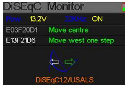
**Pow:** Die Stromversorgung der Eingangskabelleitung.
